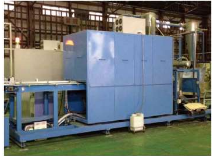
ラマン分光プラスチックソータ (サイム・モデルRPS-250-R50)
