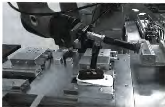
写真2 スマートフォンの自動解体機の開発(オーストリア ProAutomation 社, 筆者撮影)。
