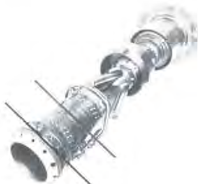
図4 ガスタービンの燃焼器 11) 。
